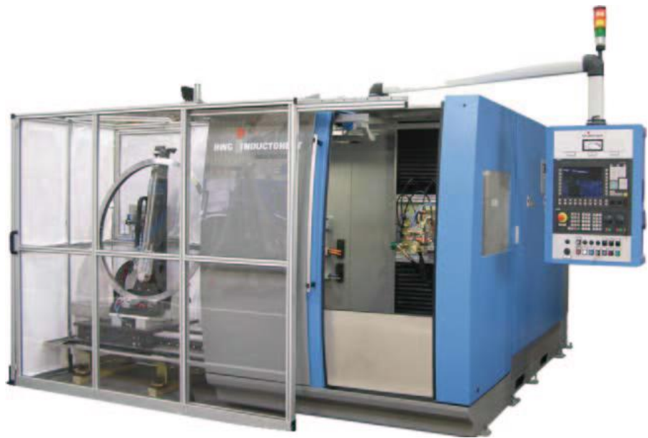
Abb. 5 — InductoScan Basiskompaktmaschine für die induktive Vorschubhärtung von Lagerringen. Die Ringe werden mit einem Kran in die Bestückungsposition geführt. Die Vorschubhärtung wird durch eine Siemens 840D-Steuerung geregelt.
