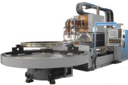
Abb. 4 — Anlage für die induktive Zahnhärtung für einen großen Lagerring, der in einer Windturbine zum Einsatz kommt. Die Zähne befinden sich am Innendurchmesser des Rings. Der Außendurchmesser des Lagerrings kann eine Größe von bis zu 140" (3.550 mm) aufweisen. Die erforderliche Härtungstiefe liegt bei 2,5 bis 3,5 mm. Die Vorschubhöhe auf der z-Achse (Zahnbreite) beträgt 13,75" (350 mm), und das maximale Gewicht liegt bei über 11.000 lb (5.000 kg).
