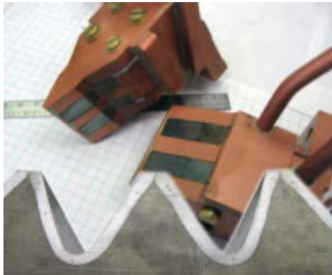
Abb. 3 — Bei der Einzelzahnhärtung können Induktoren darauf ausgelegt werden, selektiv spezielle Bereiche der Verzahnung zu härten, in denen metallurgische Veränderungen erforderlich sind (z.B. Fuß, Fußausrundung und/oder Flanke des Zahns), um eine feinkörnige martensitische Schicht bei minimaler Verformung zu erzeugen. Die übrigen Bereiche des Teils werden von dem Induktionsprozess nicht beeinflusst und behalten ihre Zähigkeit und Duktilität.
