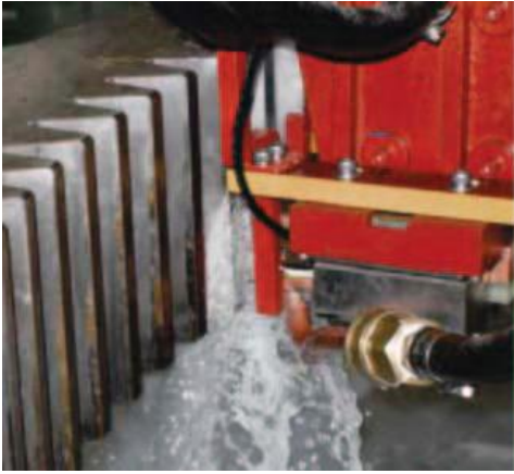
Abb. 2 — Die induktive Einzelzahnhärtung kann für große äußere und innere Zahnräder und Ritzel angewendet werden und setzt voraus, dass der Induktor symmetrisch zwischen zwei Flanken benachbarter Zähne positioniert wird.
