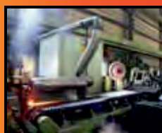
300 kW/30 kHz Produktionsrate: 30 St./min (20 x 100 mm L) kontinuierliche Endenerwärmung
